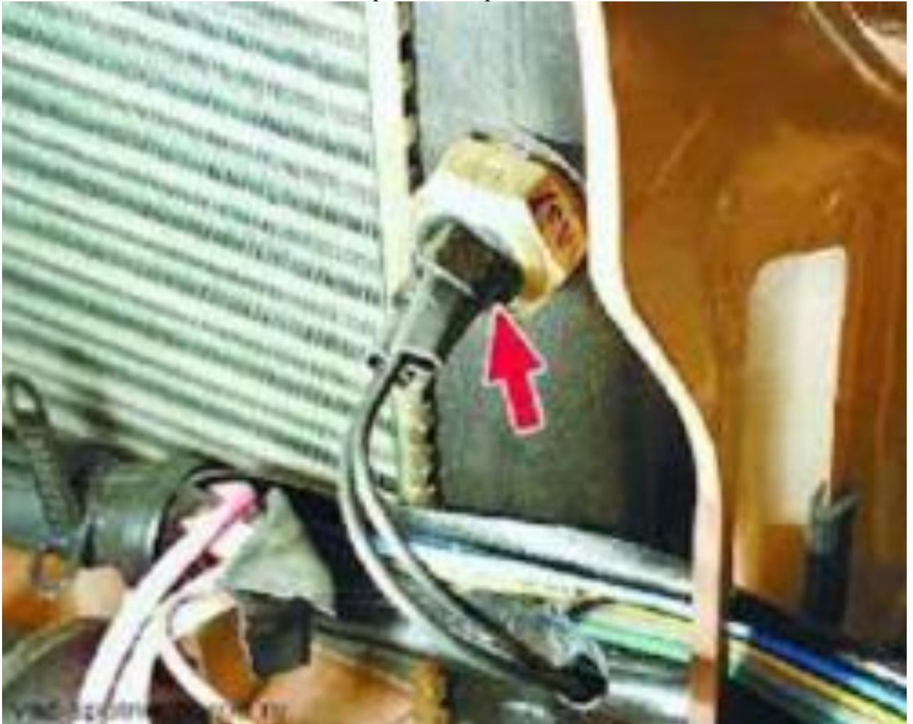
У некоторых моделей авто можно пропустить признаки перегрева из-за некорректной работы датчика и индикатора температуры. Например, долгое время считалось, что причины, по которым перегревается двигатель Калины, заложены в системе охлаждения. Показания индикатора температуры зашкаливали при отсутствии иных признаков перегрева. Причиной подобного было нарушение контакта в проводке из-за окисления клемм. По той же причине зачастую не включается электровентилятор радиатора.
